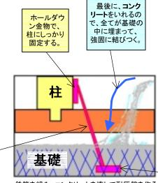
鉄筋を組み、コンクリートを流して耐圧盤を作る
